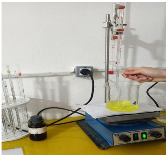
Figure 7 Dosage des ions chlorure par titrage
