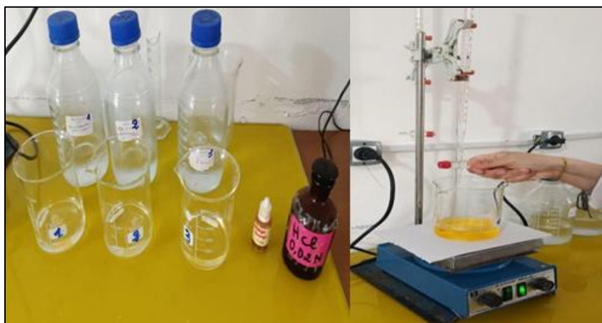
Figure 8 Le dosage de titre alcalimétrique complet (TAC)
